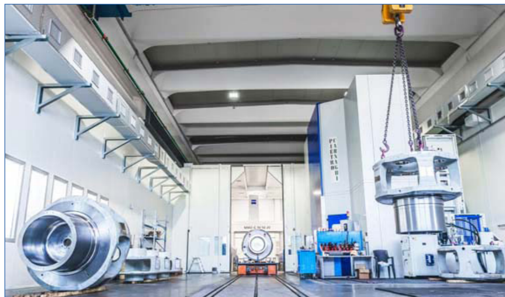
Sala metrologica con copertura apribile e carro di movimentazione su rotaia
