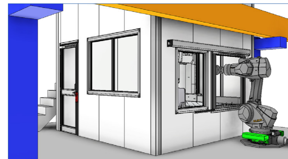
Cella di misurazione, apertura automatica per robot di carico/scarico
