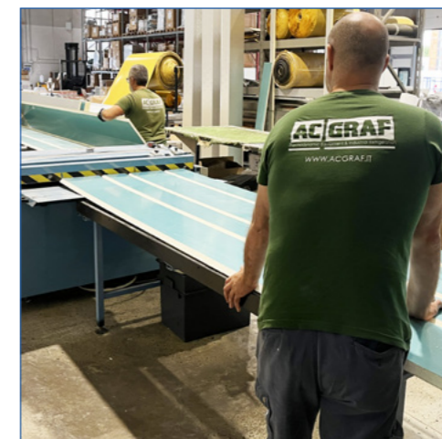
Lavorazione delle canalizzazioni
