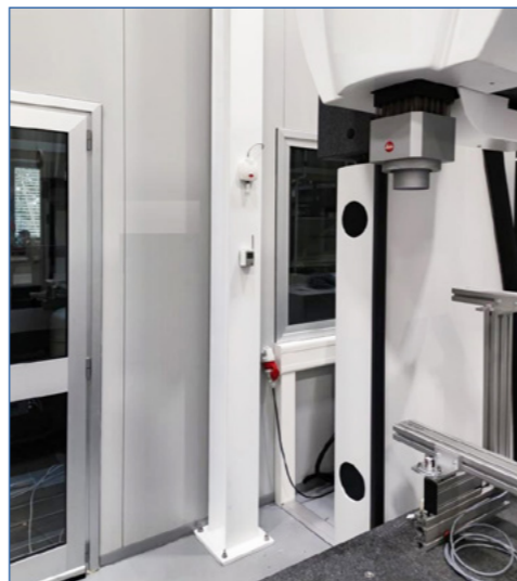
Camera climatizzata per strumento di controllo dimensionale ad elevatissima precisione
